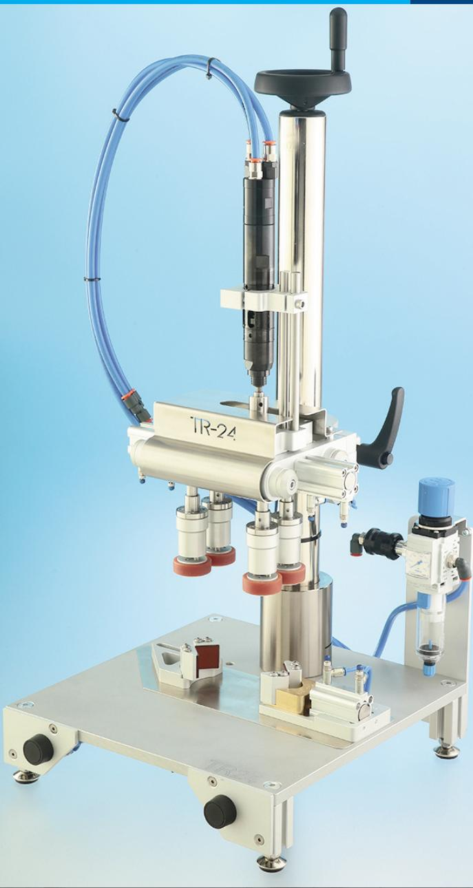
Con l'avvitatore TR24 è possibile chiudere flaconi in qualsiasi materiale dotati di trigger. Si tratta di una macchina semiautomatica da banco costituito da una struttura portante regolabile in altezza su cui sono posti quattro corpi rotanti a coppia (due per lato) da 1,2 a 1,6 N/m. La sua praticità si nota dal semplice utilizzo e dalla sua versatilità. Non necessita nessuna parte elettrica per il suo funzionamento.
